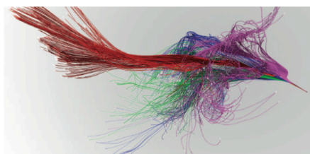
Esempio di dispersione di nuvole di particelle emesse da una sorgente localizzata in un fluido turbolento. La figura mostra 4 tipi di particelle differenti al variare della loro densità (colorate in modo differente). Le particelle possono rappresentare differenti sostanze chimiche o traccianti trasportati dal fluido turbolento sottostante.
